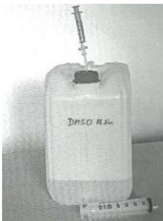
Figura 13: Recipiente con sistema de extracción y filtro
